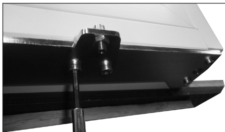
19. Fjern håndtagets nederste låsetap- plade ved at løsne to skruer (brug 4 mm unbrakonøgle).
