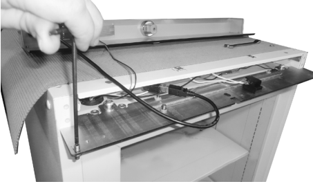
13. Drehzapfen festziehen (2,5 mm Inbusschlüssel)
