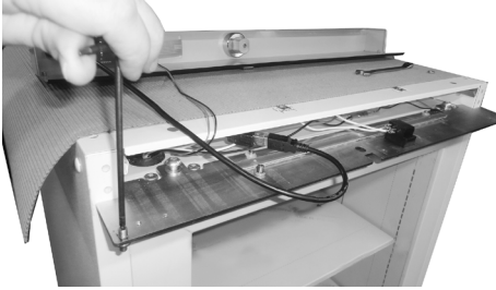
13. Tighten pivot (2,5 mm allen key)
