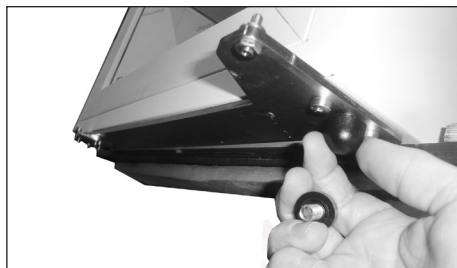
18. Fjern de to fødder foran.
