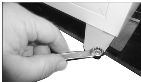
24. Monter og spænd hængseltapmøtrik- ken.
