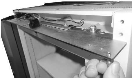
11. Loosen door top pivot (use 2,5 mm allen key if necessary)
