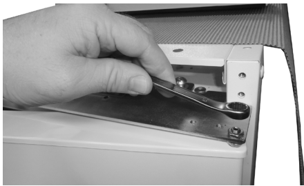
9. Loosen pivot nut (use 10 mm spanner)
