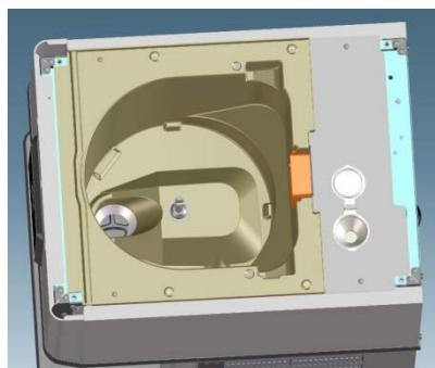
5. Replacez le bouchon de l'entonnoir et réinstallez tous les pièces retirées précédemment en suivant la procédure dans l'ordre inverse et en veillant à ce que la lame d'acier et l'axe supérieur de la lame soient correctement fixés.
