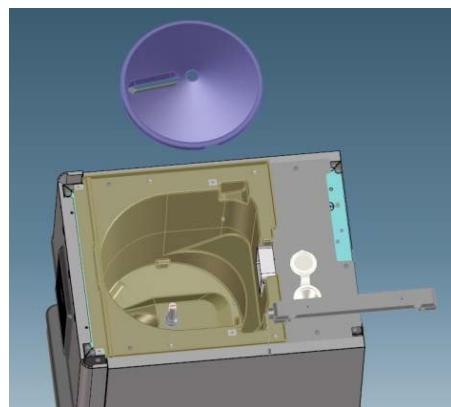
7. Utilizzando la stessa caraffa preparare nuovamente 500 ml di acqua calda ( 40-50° C) con 15 ml di prodotto Sanitizzante Scotsman, versare la soluzione sulla parete interna del contenitore
