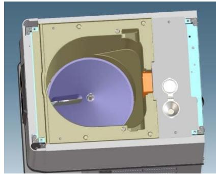
2. Dévissez les deux vis de fixation puis retirez le couvercle du bac.
